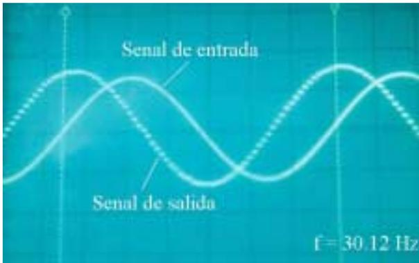
**Figura 10.** Señales de entrada y salida observadas en el osciloscopio con  $f < f_c$
